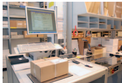
Die Paketwaage ermittelt Gewicht und Preis und schickt die Daten direkt an DHL.
